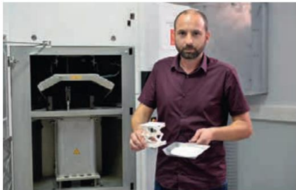
De la poudre à l'objet, au Centre des Matériaux de l'EMA, Marcos Batistella utilise dans ses recherches une machine à laser pour créer des objets complexes d'une seule pièce.
